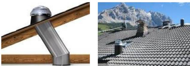
Composto da un captatore con dispositivo ottico, un condotto tubolare riflettente e un diffusore (plafoniera), il sistema permette di trasportare a tutti gli ambienti – anche a distanza dal captatore – la massima quantità di luce ricavabile dalla luminosità del cielo.
